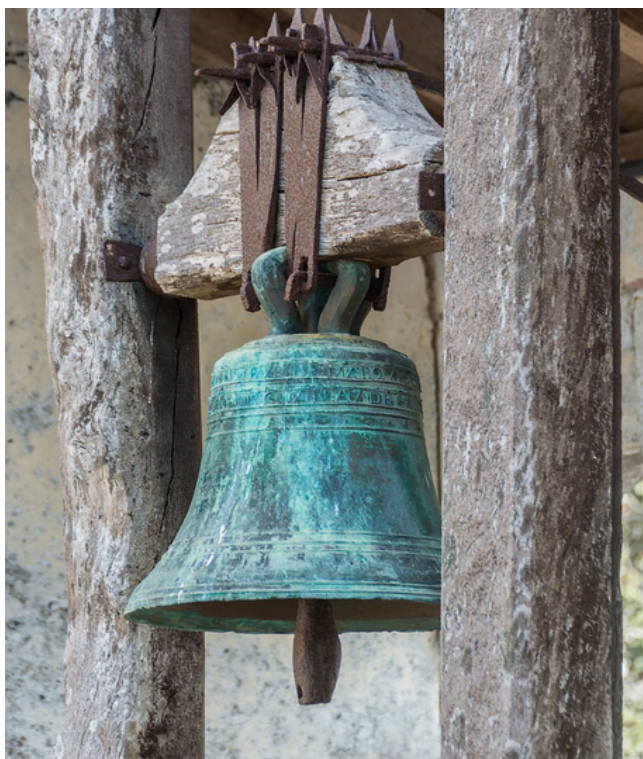
Σχήμα 3: Πατίνα σε καμπάνα από κράμα χαλκού – χαρακτηριστικός σχηματισμός βασικών ενώσεων χαλκού [7]
